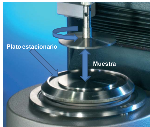
Figura 2.4. Esquema de una celda de platos paralelos (fuente: adaptado de Thermofisher, http://thermofisher.cn/Resources/200802/productPDF_2936.pdf )
