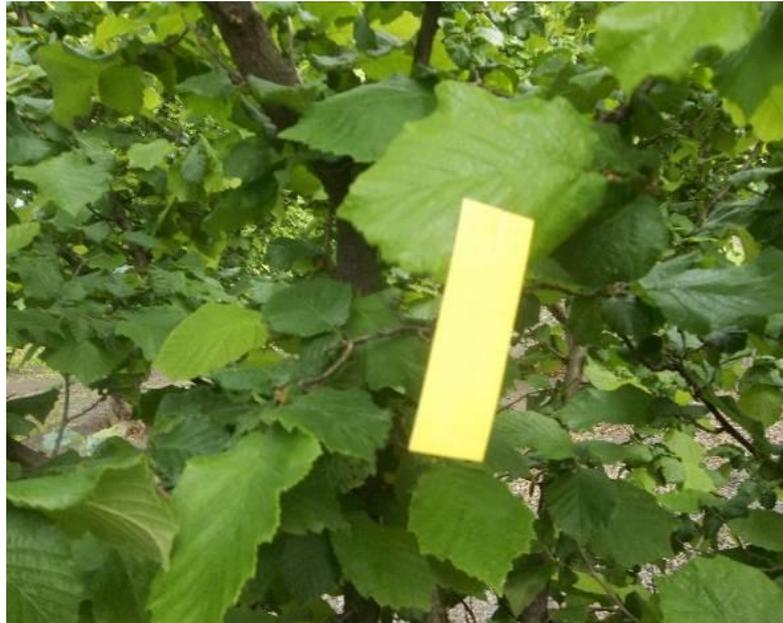
**Figura 4.** Tarjeta hidrosensible para el control de la calidad de la pulverización con fertilizante ubicada en la parte media de la copa del árbol.
