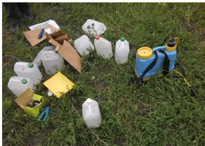
**Figura 3.** Mochila de pulverización manual de 10 l de capacidad, bidones con urea en solución.
