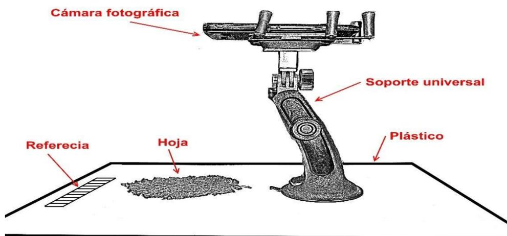
**Figura 5.** Montaje para fotografía de hojas de avellano.
