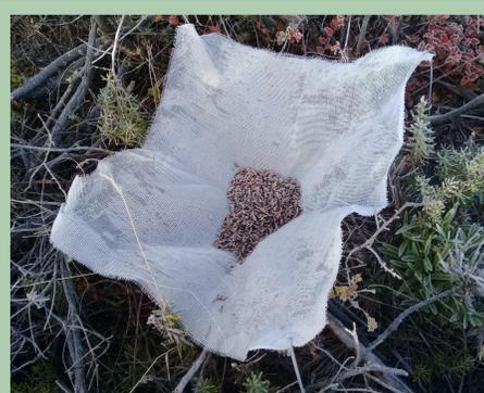
Fig. 2: Colector de malla plástica de 0.25 m<sup>2</sup> (malla de 1 mm de apertura)
