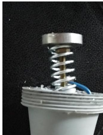
Imagen 6. (clara inclinación del cabezal lo cual genera una tendencia de propagación del haz ultrasónico que genera una falta de homogeneidad en la energía emitida hacia el tejido)
