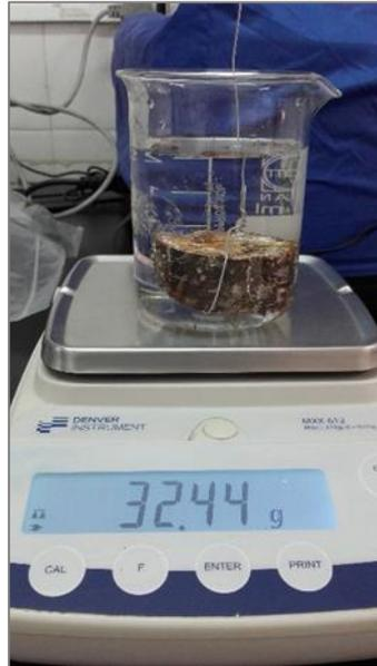
Figura 5: Determinación de densidad de la madera por método de Arquímedes.
