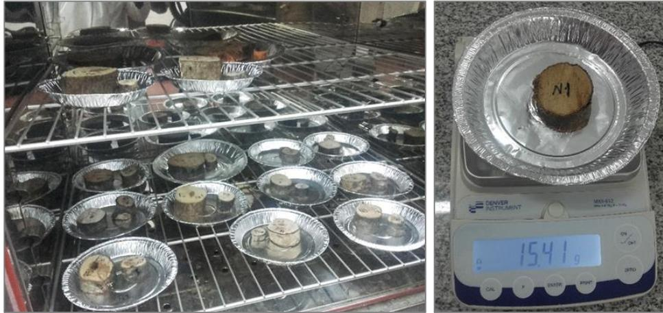
Figura 4: Secado y pesaje del material leñoso en el laboratorio.
