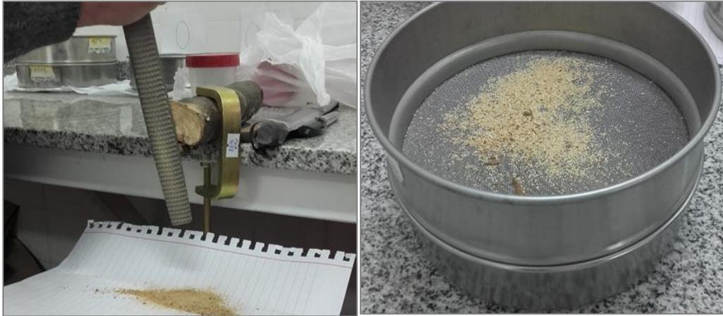
Figura 6: Pulverización del material leñoso mediante escofina y tamizado.
