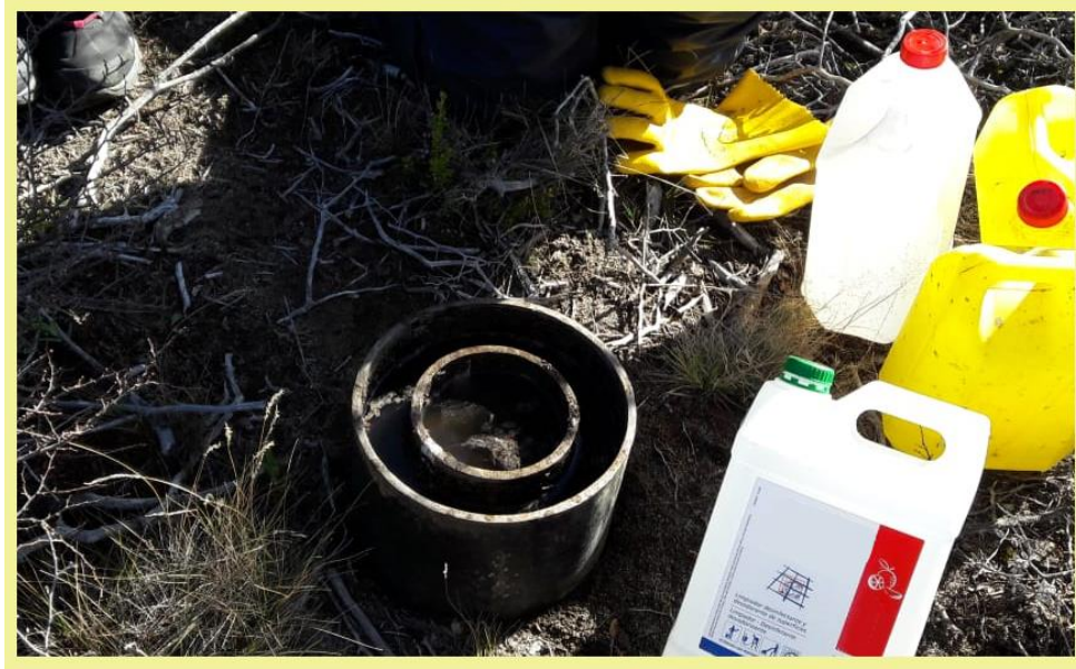
Figura 8: Ensayo de infiltración: se muestran los dos anillos del infiltrómetro clavado en el suelo del área de referencia, junto con los bidones de agua necesarios para realizar el ensayo. Fuente: propia.
