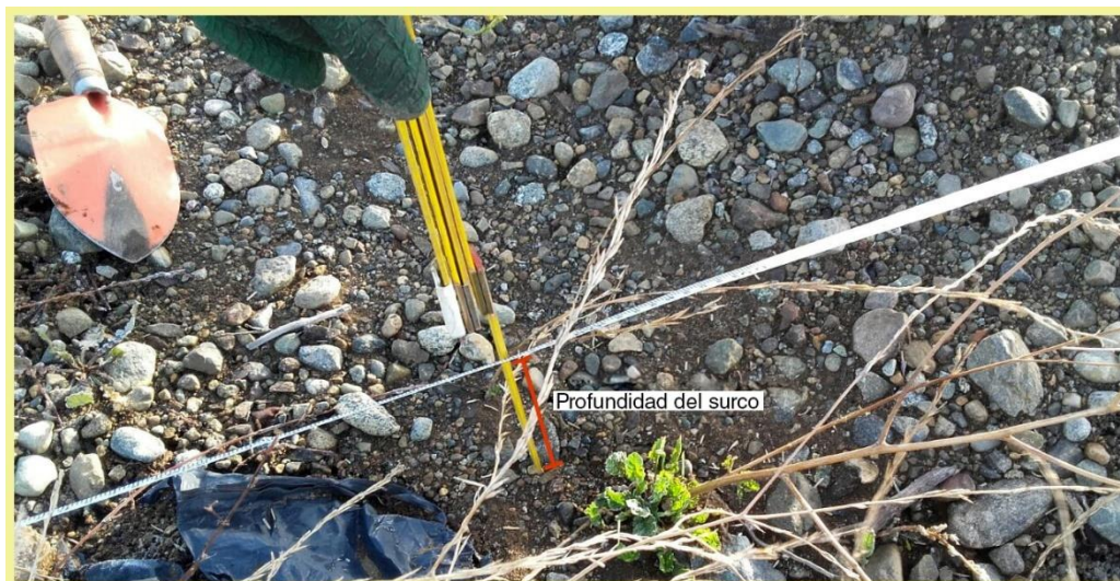
Figura 6: Medición de longitud y profundidad de surco: con la cinta métrica se mide la longitud y con un metro plegable de carpintero se mide su profundidad. Fuente: propia.
