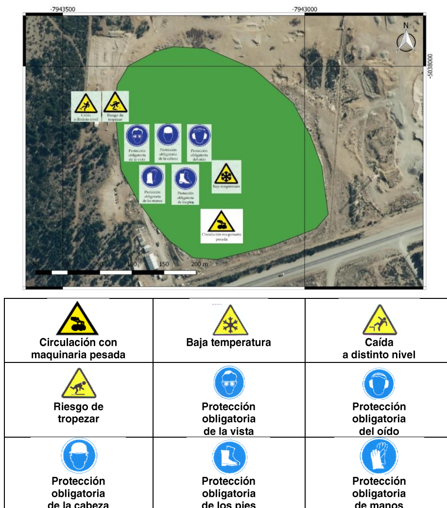
Figura 3: mapa de riesgo para la tarea 4: señalización. En la figura se muestra en verde la cobertura final del ex basurero, sobre una imagen satelital. Los símbolos en azul son de obligatoriedad y en amarillo son símbolos de precaución o advertencia. Fuente: elaboración propia.
