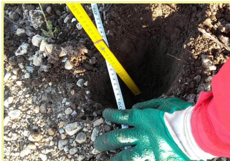
Figura 11: Medición de profundidad del sustrato que cubre la geomanta con un metro plegable. Fuente: propia.
