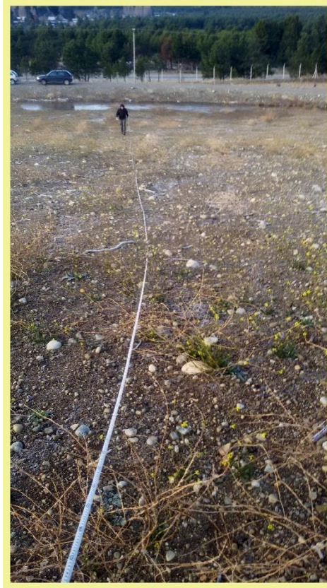
Figura 10: Medición de pendiente del talud Sur del ex basurero mediante una cinta métrica y un clinómetro. Fuente: propia.
