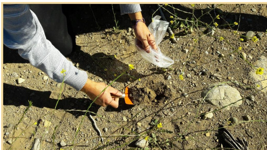
Figura 12: Toma de muestra de humedad con una pala de jardinería y una bolsa plástica. Fuente: propia.
