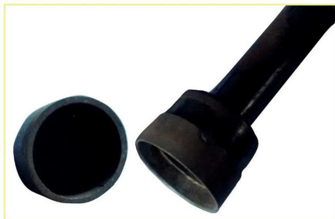
Figura 9: Muestreador utilizado para medir la densidad aparente del sustrato. Fuente: propia.
