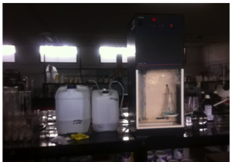
Figura 25. Equipo de destilación Foss-tecator para tubos de 100 ml. Tanques de reserva de NaOH y agua desmineralizada.
