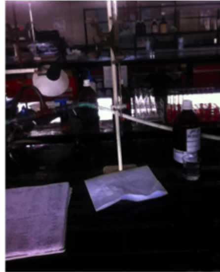
Figura 26. Bureta graduada con H_2SO_4 al 0,02N utilizada para la titulación.
