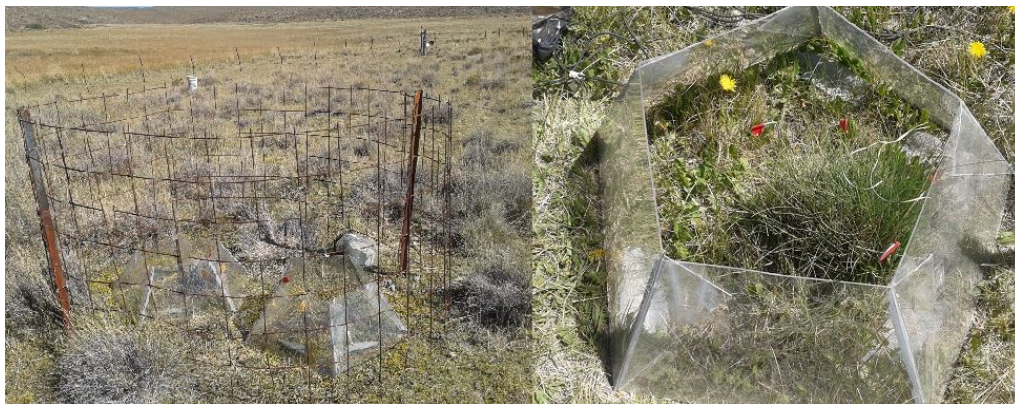
Figura 11. Clausuras con cámaras de efecto invernadero instaladas y sensores para registro de humedad y temperatura. OTC: “open top chambers”.
