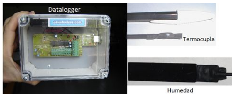
Figura 13. Datalogger Cava devices ® y sensores de temperatura y humedad edáfica
