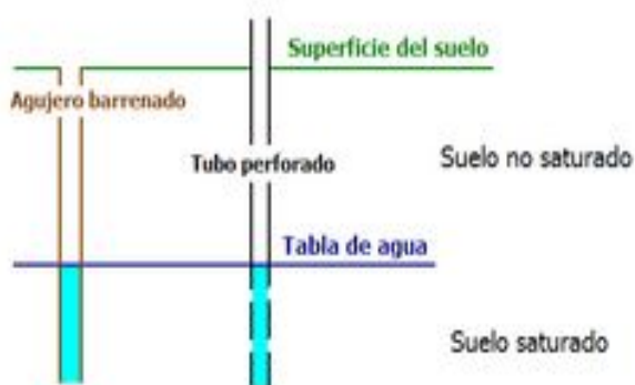
Figura 14. Modalidad de funcionamiento de freáticos.
