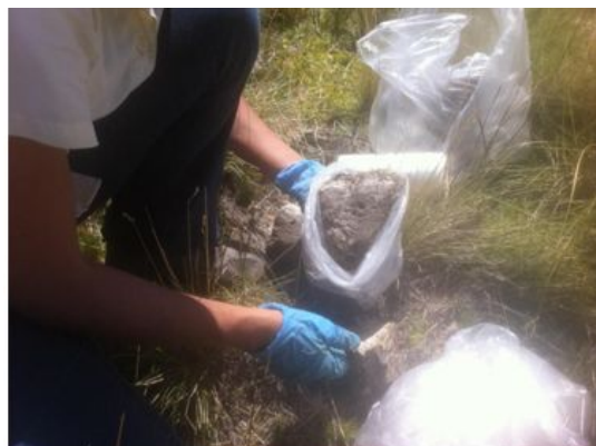
Figura 12. Muestreo no disturbado de los primeros 5 cm de suelo en Cañadón Bonito.
