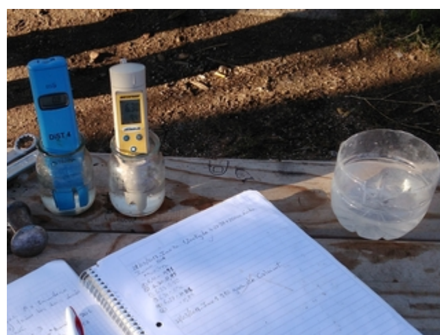
Figura 28: Medición de pH y CE agua de fertirriego.
