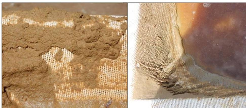
Figura N° 6: Material retenido en filtro de tela que utilizaba el productor
