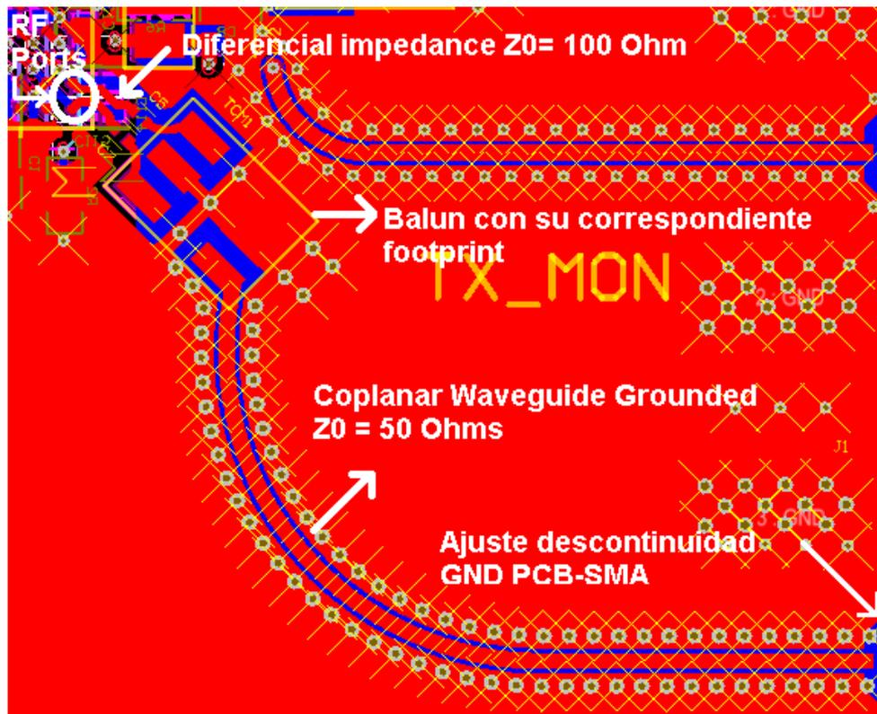
Figura 5-16: Ruteo sección de RF transceiver AD9364
