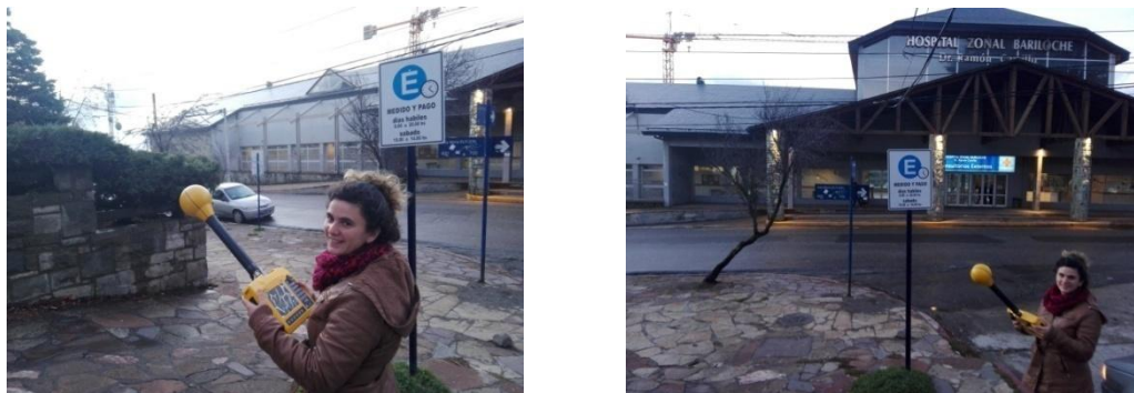
Figura 4 Punto de medición en el Hospital Zonal de S. C. de Bariloche, 06/06/2019, en donde se registraron valores de densidad de potencia más altos que en el resto de los puntos, más cercanos a la entrada del hospital.
