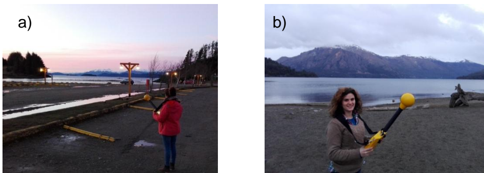
Figura 3 Medición de la densidad de potencia electromagnético con el equipo Narda SRM 3006 y la antena isotrópica “Three-axis antenna (E-Field) 3501/03”. a) Puerto Pañuelo. b) Playa Lago Gutiérrez, Bº Los Coihues.
