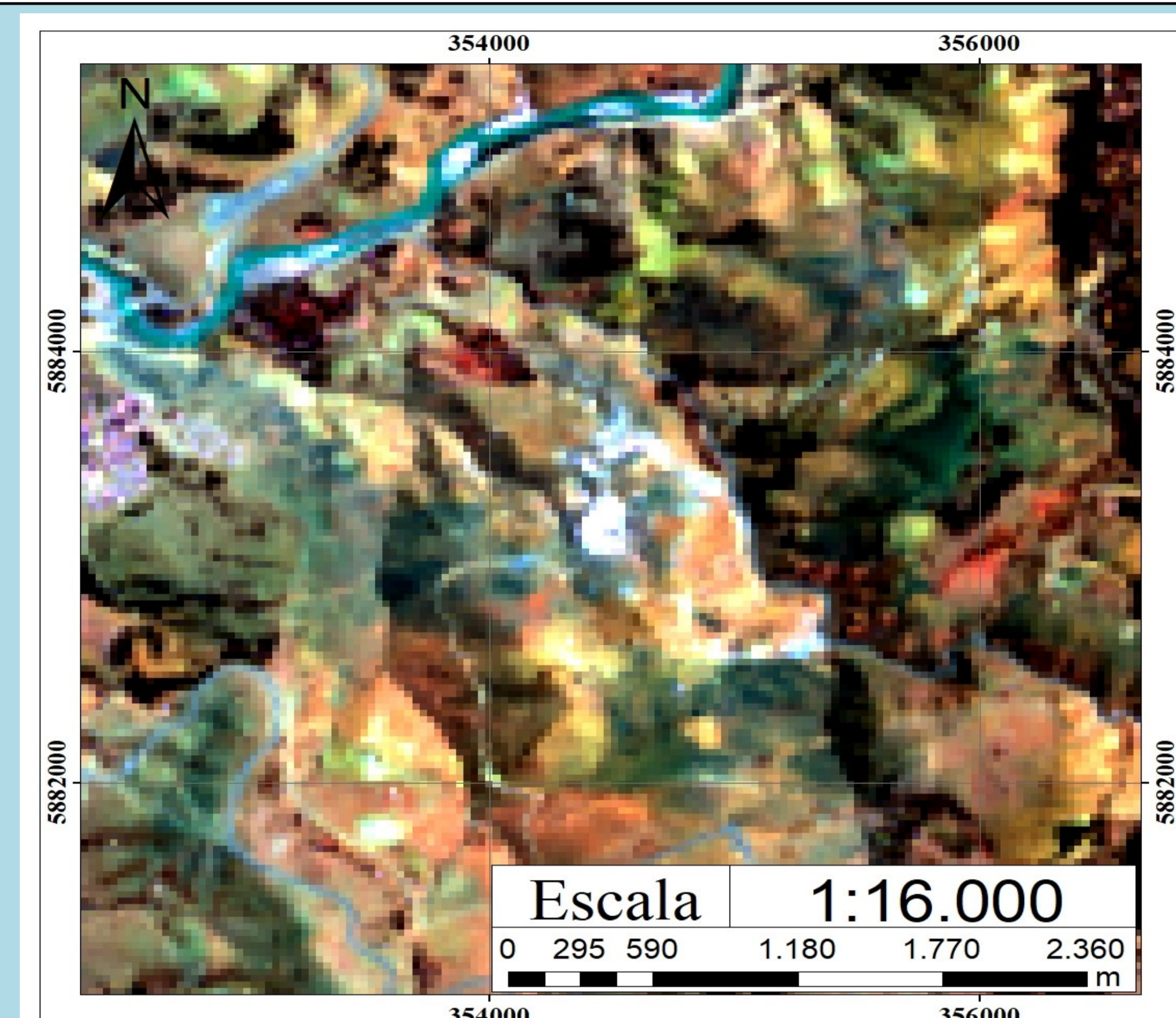
Figura 2: Imagen satelital Landsat 8 en combinación RGB 7_4_2, procesada con un filtro lineal del 2% en el Software ENVI 4.5.
