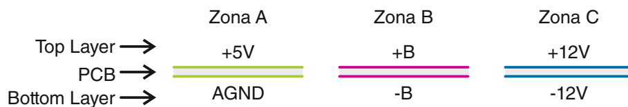
Figura 4.26.: Planos de referencia en zonas del PCB
