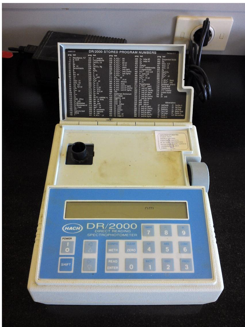
Figura 7.6 – Espectrofotómetro DR/2000 utilizado en las determinaciones colorimétricas de los protocolos HACH (Laboratorio CEB)
