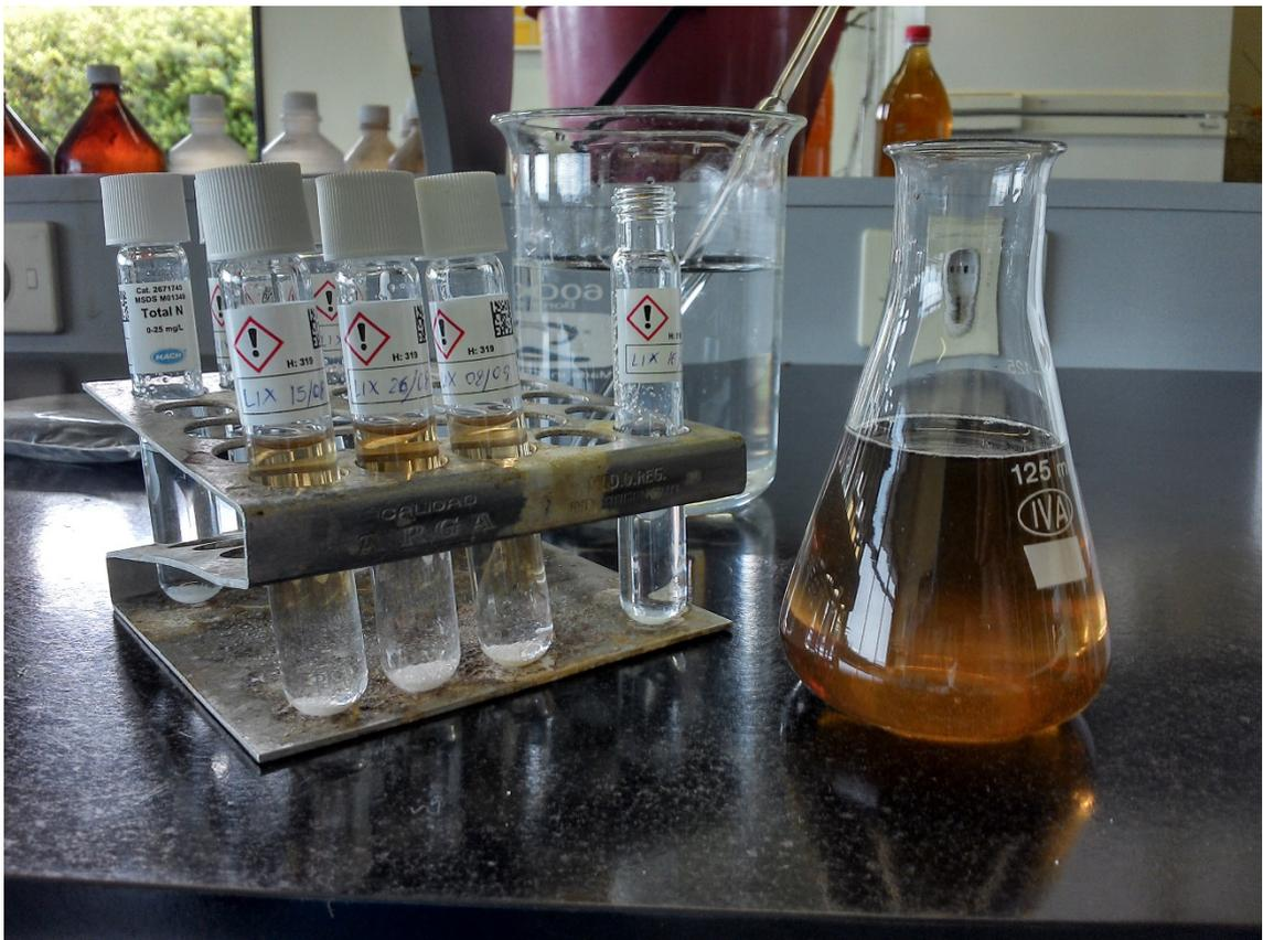
Figura 7.2 – Determinación de nitrógeno total en lixiviados (Laboratorio CEB)
