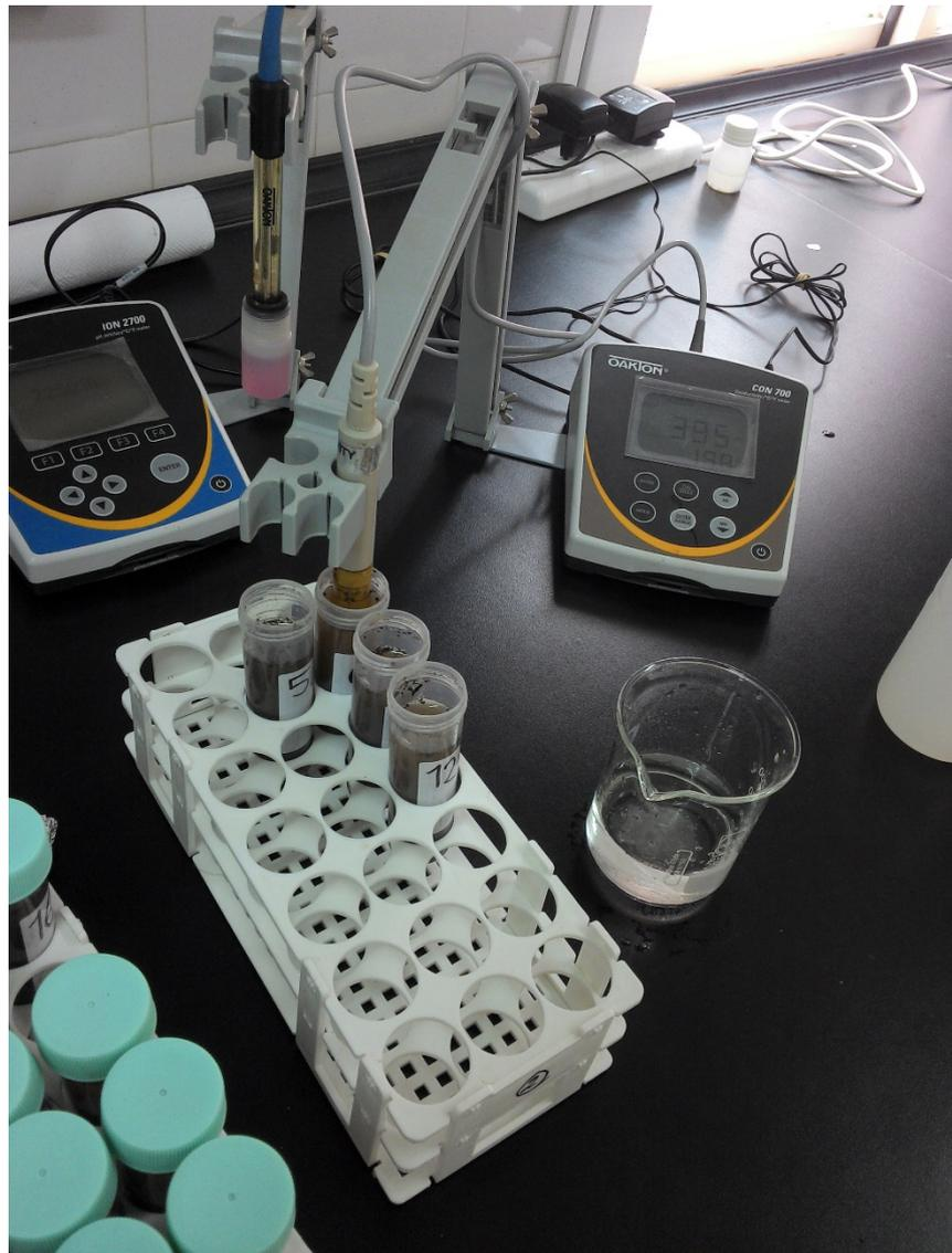
Figura 7.9 – Determinación de conductividad eléctrica en suspensión del sustrato de crecimiento de las macetas (Laboratorio UNRN)
