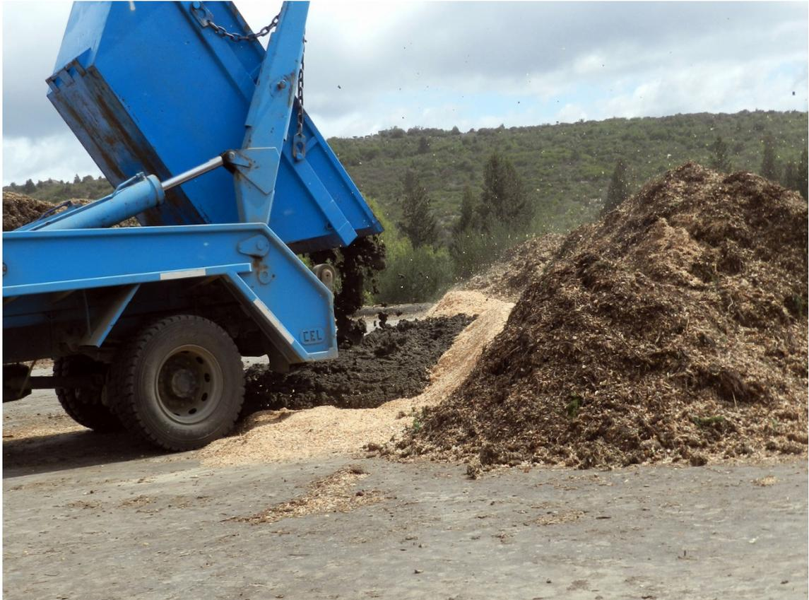
Figura 2.7 – Mezclado de los biosólidos con viruta de madera en la planta de compostaje
