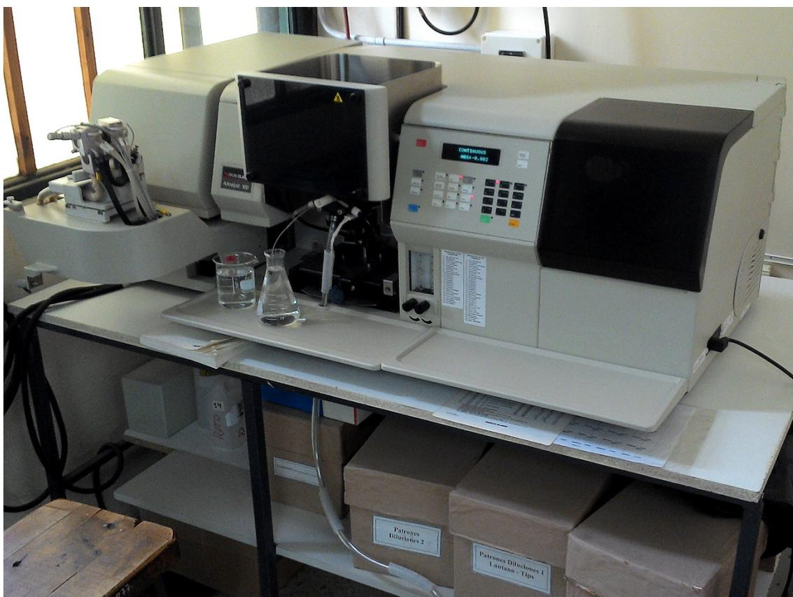
Figura 7.14 – Espectrómetro de absorción atómica PerkinElmer AAAnalyst 100 (Laboratorio CRUB)
