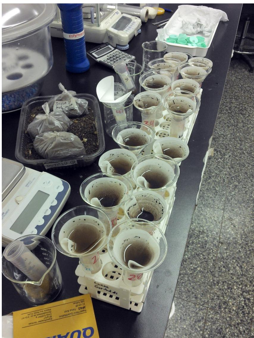
Figura 7.10 – Determinación de fósforo extraíble en suspensión del sustrato de crecimiento de las macetas (Laboratorio UNRN)
