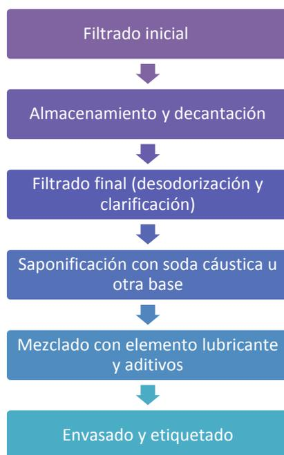
Figura: Proceso de reciclado de aceite para fabricación de grasas
