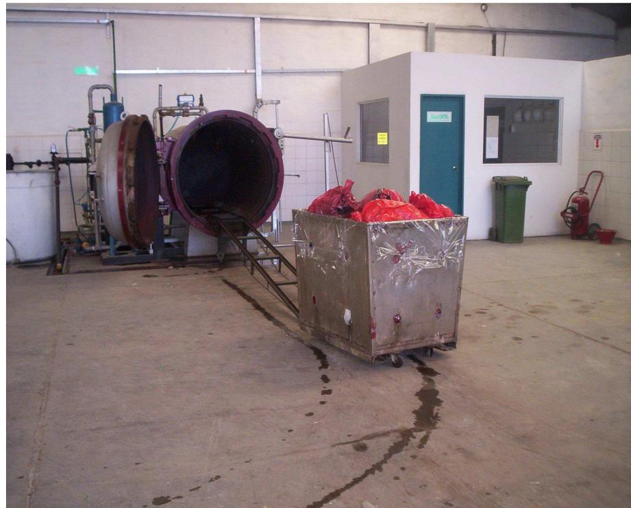
Foto 20 y 21 Carga y operación del autoclave (empresa Zavecom).
