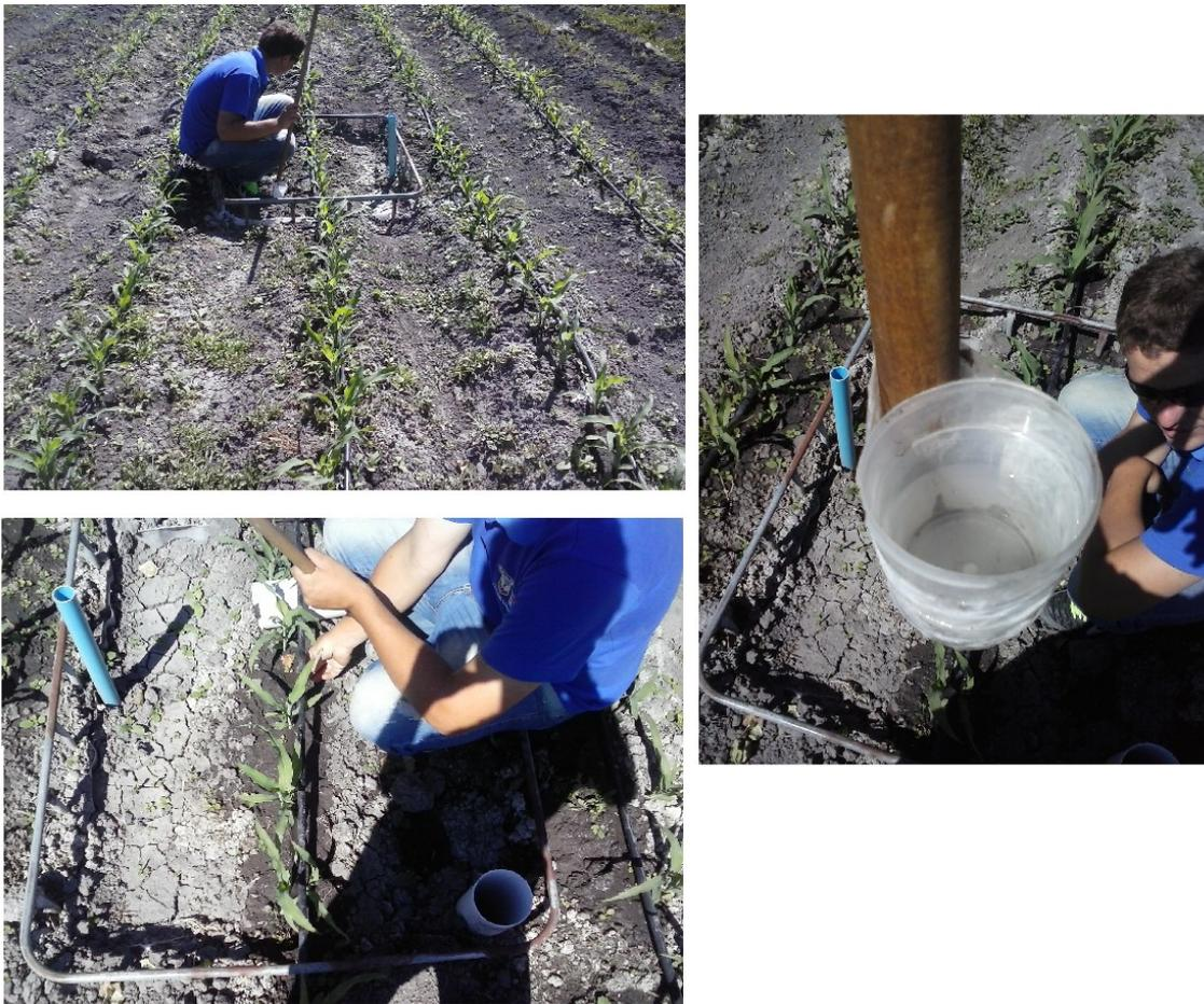
Figura 11. Medición del caudal de los goteros.
