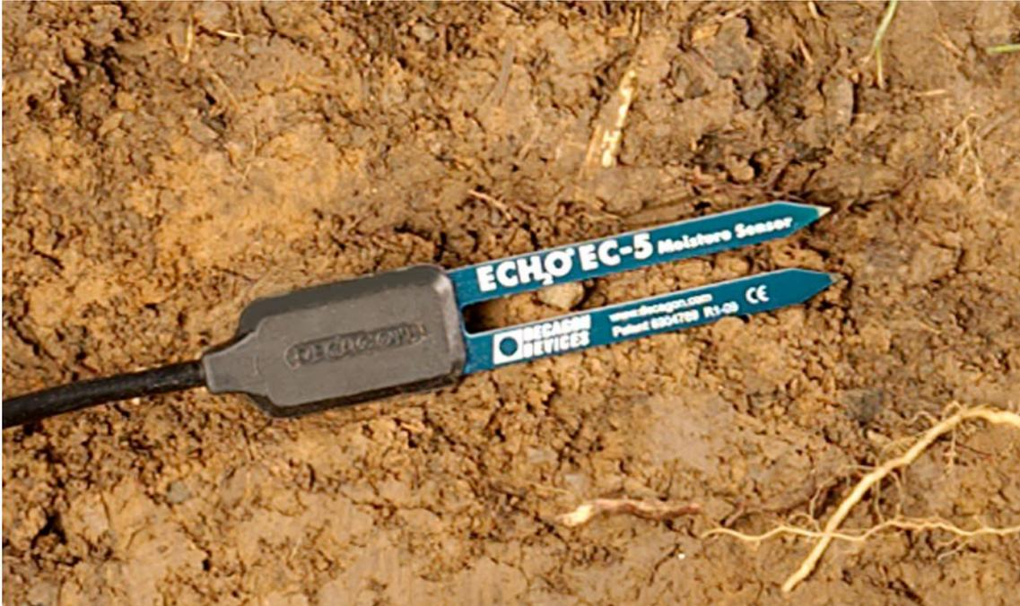
Figura 3. Sensor ECH2O utilizado durante las campañas 2014/15 y 2015/16 para la medición del contenido volumétrico de humedad del suelo dentro del lisímetro.
