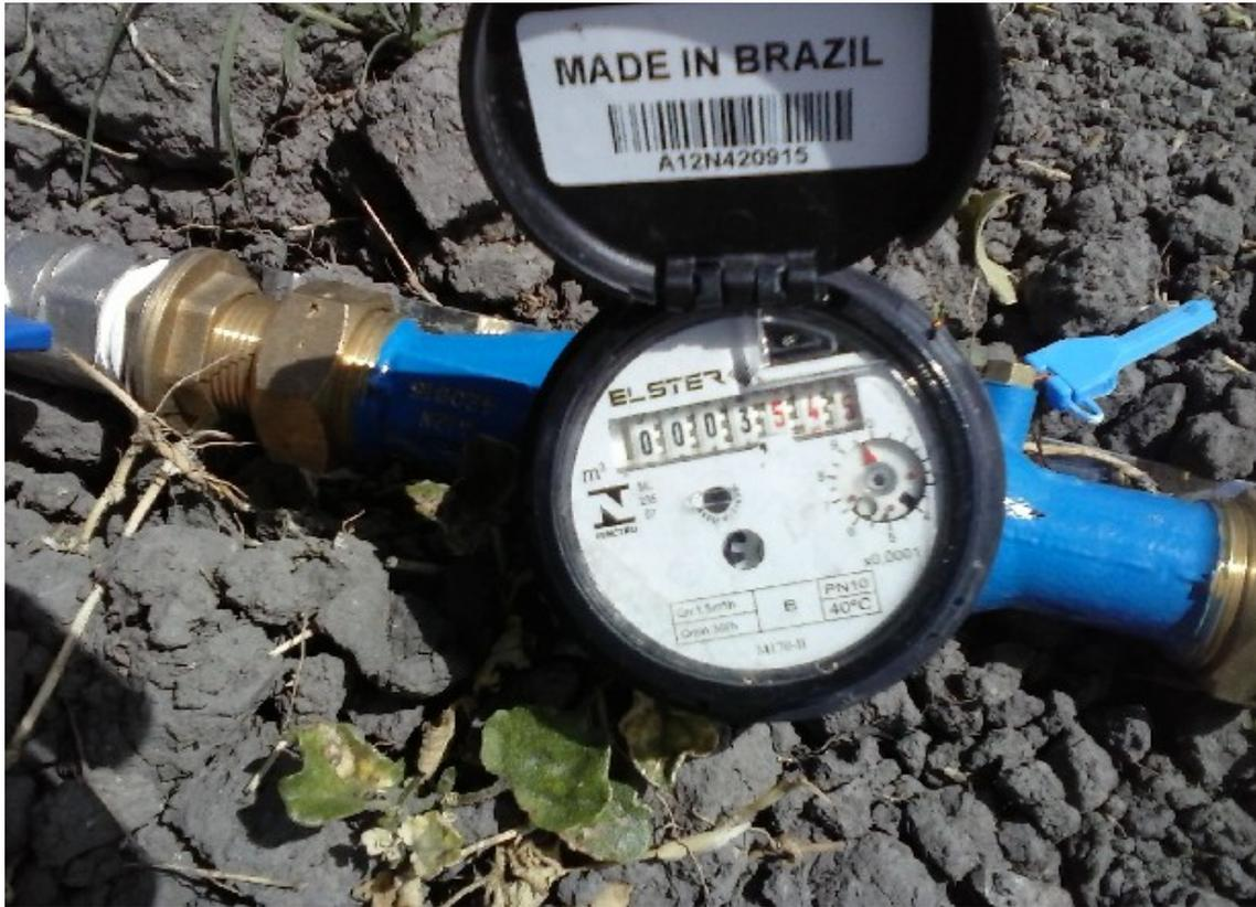
Figura 9. Caudalímetro utilizado para la medición del volumen de agua aportado al lisímetro.
