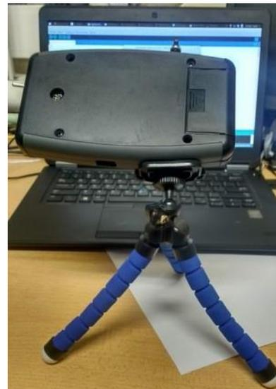
Figura 2. Dispositivo armado e instalado del LightSound 2.0 en un trípode
