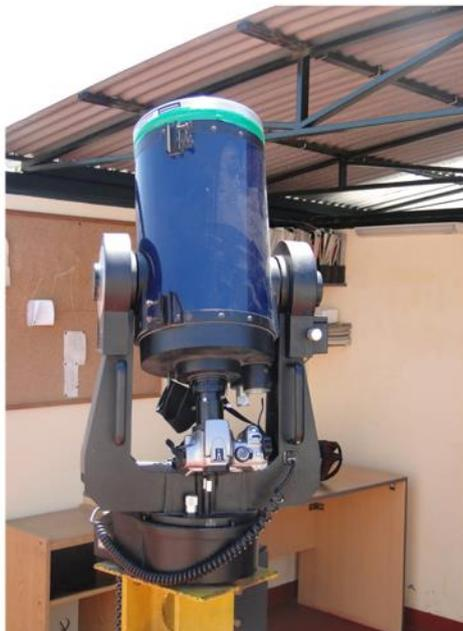
Figura 2: Instrumental utilizado en las mediciones. La cámara Canon EOS 300D se acopla al foco primario del telescopio para dar una escala de aproximadamente 1 arcsec/pixel, que implica una resolución angular nominal de aproximadamente 0.05% del diámetro lunar.
