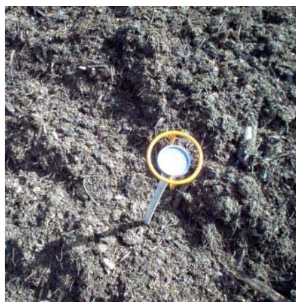
Figura N° 29 Medición de temperatura en la pila de compost . Fuente: imagen propia.
