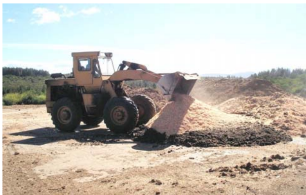
Figura N°25 Proceso de mezcla de componentes del compost. Planta de compostaje de San Carlos de Bariloche. Fuente: imagen propia
