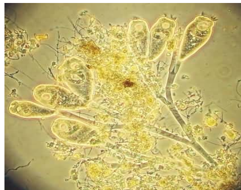
Figura N° 9 La vorticella, es una hermosa representante de los ciliados fijos, presentes en el licor mezcla
