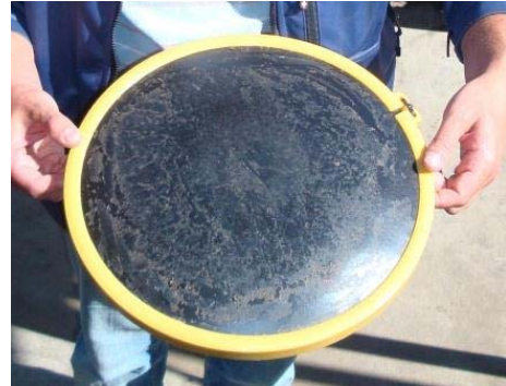
Figura N° 15 Difusor. Fuente: imagen propia
