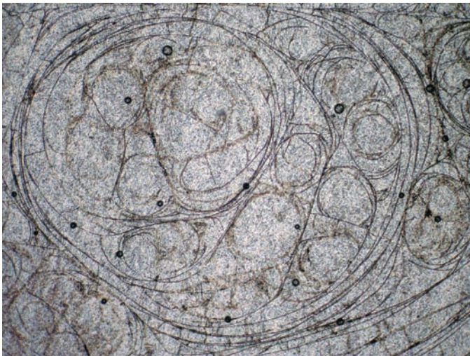
Figura 12.26: Fotomicrografía de grietas perlíticas en un domo de vitrófiro del Complejo Volcánico Piroclástico del Río Chubut Medio. El diámetro de la perlita mayor es alrededor de 1 mm. La sección delgada fue cedida por cortesía de E. Aragón.
