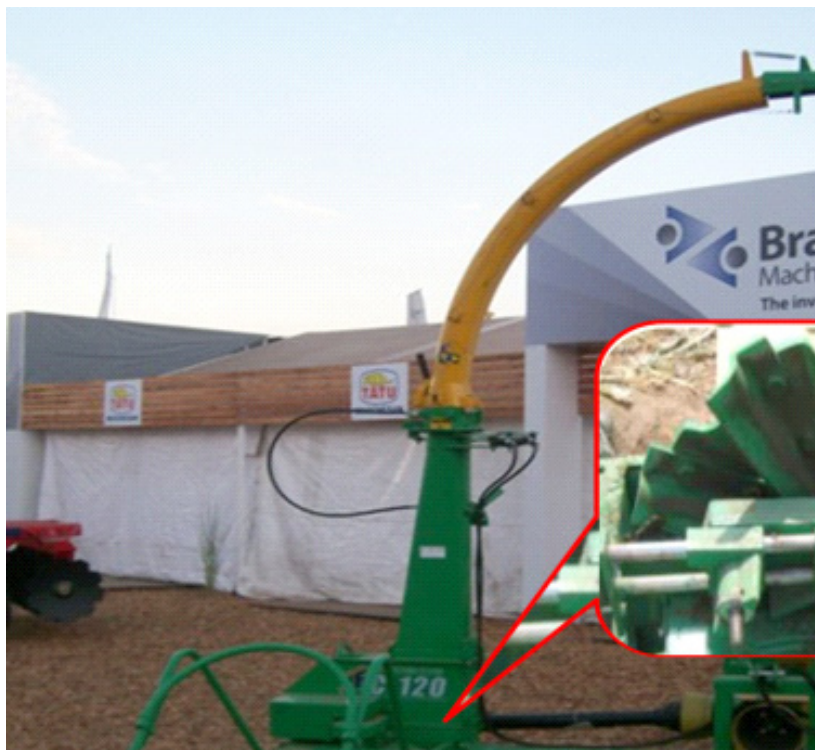
Figura 11. Picadora de un surco de maíz, con enganche tres puntos para tractor, con volante de picado
