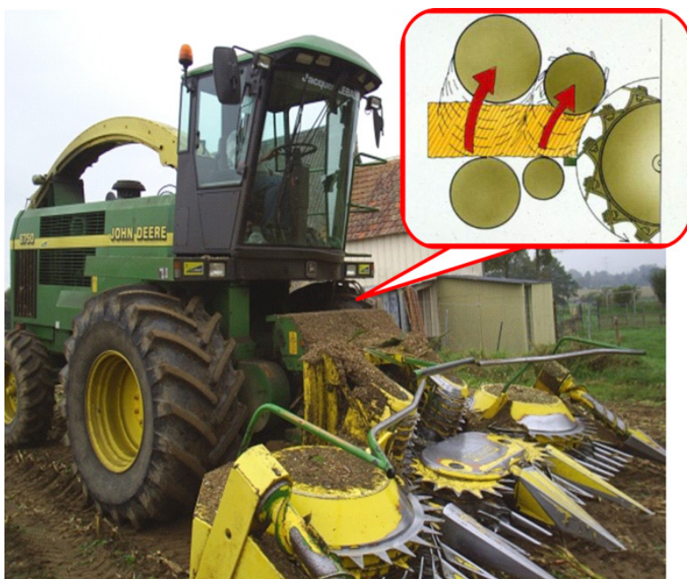
Figura 12. Picadora autopropulsada que presenta un rotor picador.
