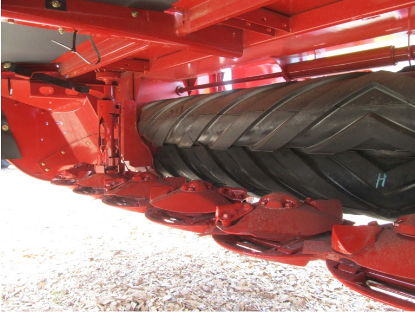
Figura 7. Acondicionador de rodillos montado sobre una segadora de disco
