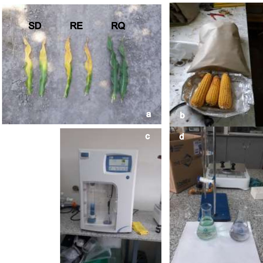
Figura 6. Etapas para la obtención de proteína en planta entera y en grano. a) Hojas basales de los tratamientos (nótese la removilización de nitrógeno en SD y RE). b) Secado de las muestras. c) Digestión. d) Titulación final.
