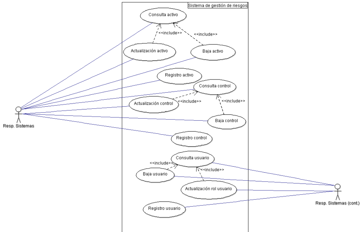
Figura 4.3. Diagrama de casos de uso para el responsable de sistemas. Elaboración propia.
