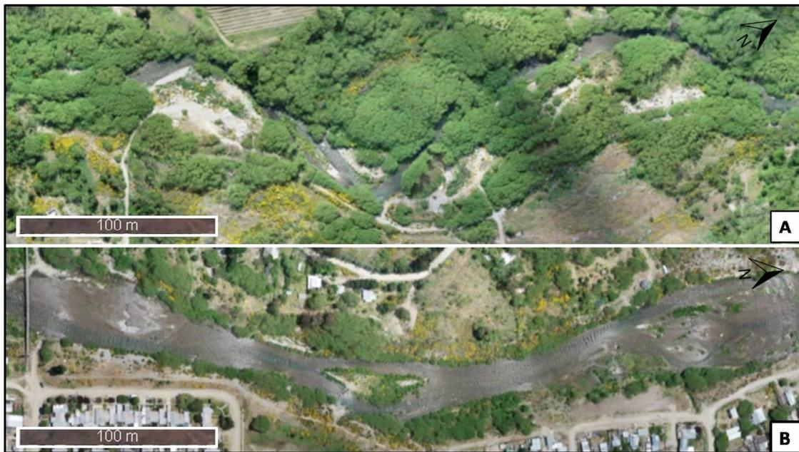
**Figura 3.19. Diferencia en planta de un tramo sinuoso (A) y uno recto (B). Imágenes aéreas tomadas con VANT.**
