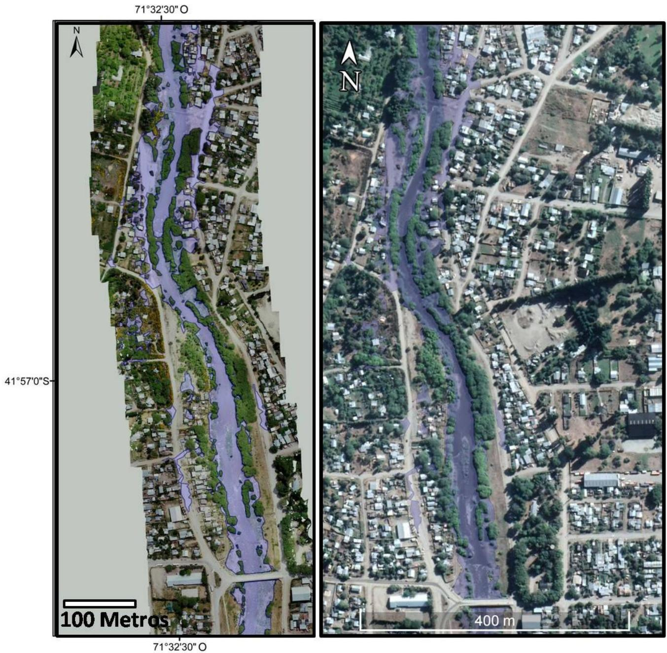
Figura 3.44. Izquierda: línea de ribera sobre ortomosaico generado con VANT. Derecha: línea de ribera en formato KML sobre imagen satelital de Google Earth.
