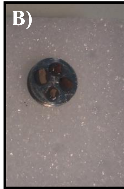
Figura 14: A) Descripción detallada de la muestra de areniscas arcillosas. B) Los aglomerados modélicos extraídos del pozo EX40 y EX70, son pegados en el portamuestra circular de acero.
