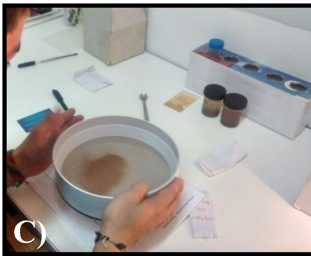
Figura 16: A) Difractor de rayos X (DRX) del Instituto de Investigación en Paleobiología y Geología (IPPG) Universidad Nacional de Río Negro (UNRN)-CONICET. B) Trituración de la muestra en un mortero. C) Tamización de la muestra en una malla de 74 micrones. D) Muestra colocada en un portaobjeto para luego ser analizado por DRX.
