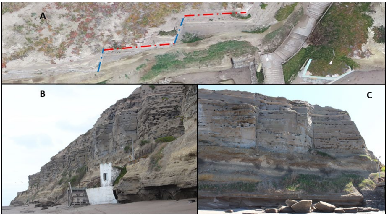
Figura 3.26. Diferentes vistas del mismo frente de acantilado donde podemos observar las discontinuidades que son paralelas (en color rojo, familia B) y perpendiculares al acantilado (en color azul, familia C). A. vista en planta. B. vista lateral. C. vista frontal.
