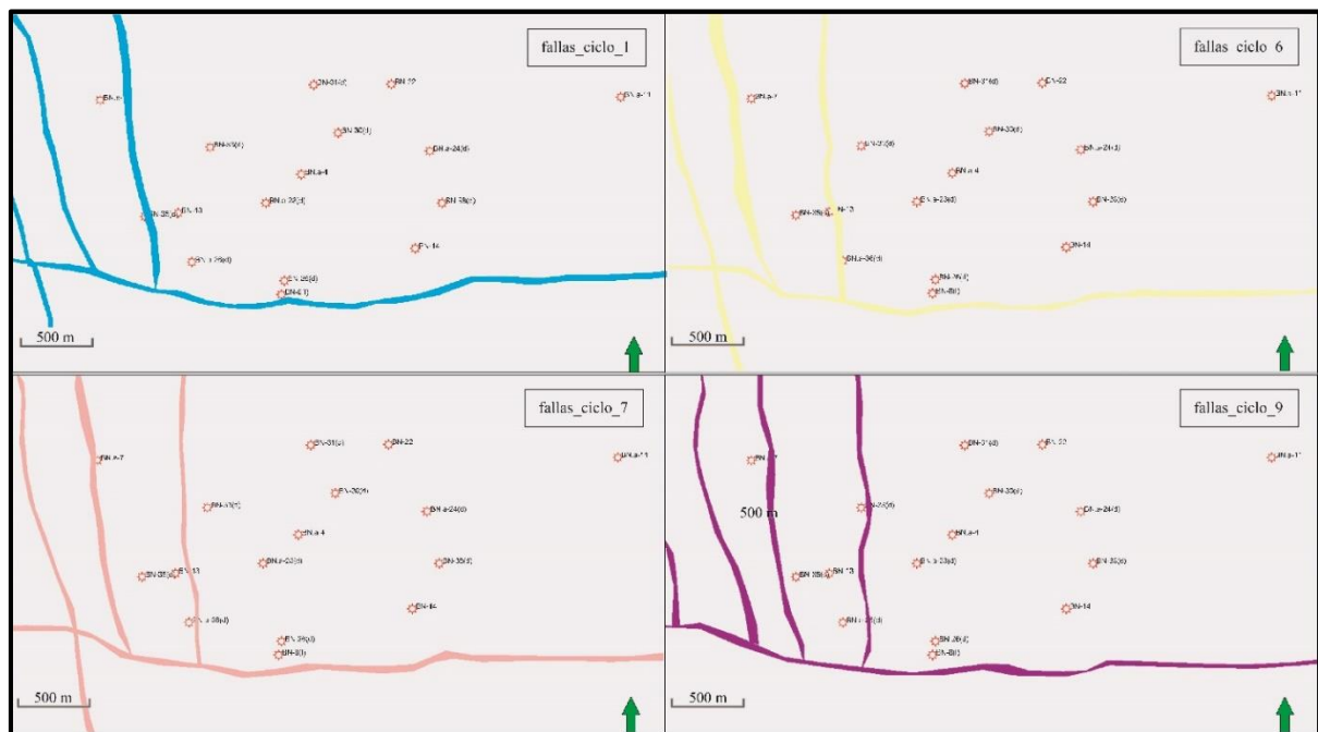
Figura 25. Fallas utilizados en el modelo. Cada falla se corresponde con una superficie estructural creada (por ejemplo el horizonte Superficie_L_Inf se asocia con fallas_ciclo_1); se aplicaron los ciclos de fallas a los horizontes creados para generar las superficies estructurales.
