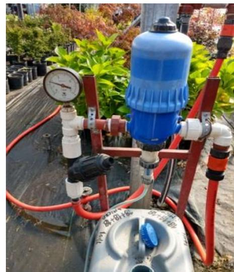
Figura 18: Dosatron para aplicar solución fertilizante al sistema de riego.
