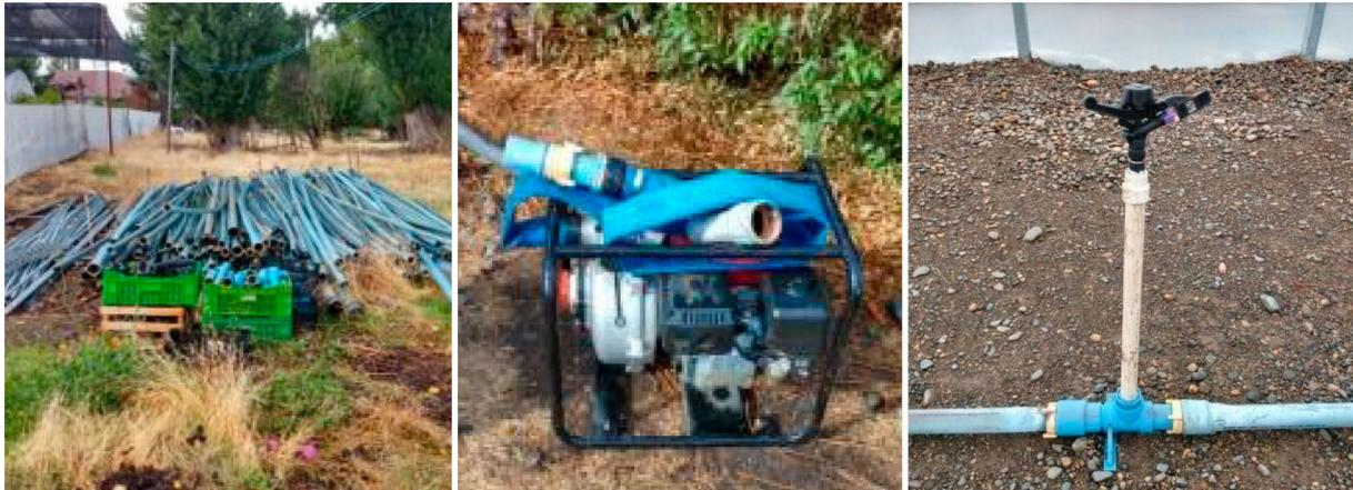
Figura 12 Bomba de agua a explosión, aspersor para riego y caños de acople rápido.
