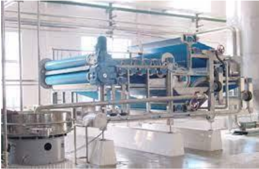
Figura 9: máquina de prensado de la fruta, para obtener el zumo de manzana
