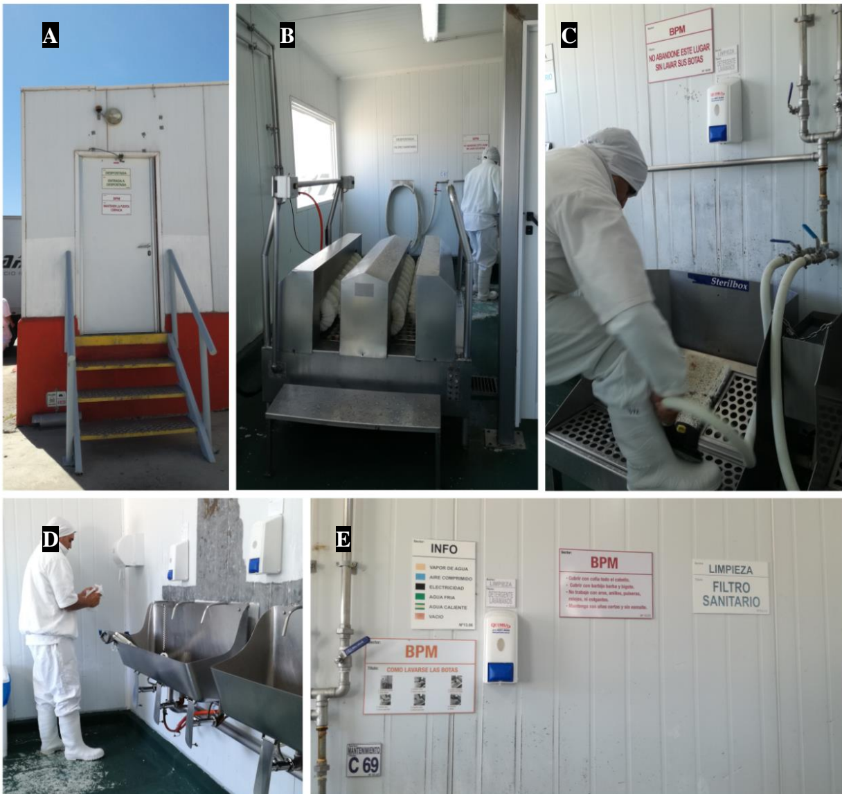
Figura 16 - A).Ingreso al área de despostada. B).Lavabotas automático. C).Lavabotas manual. D).Lavamanos. E).Cartelería con las instrucciones de lavado y las BPM. Fuente propia.
