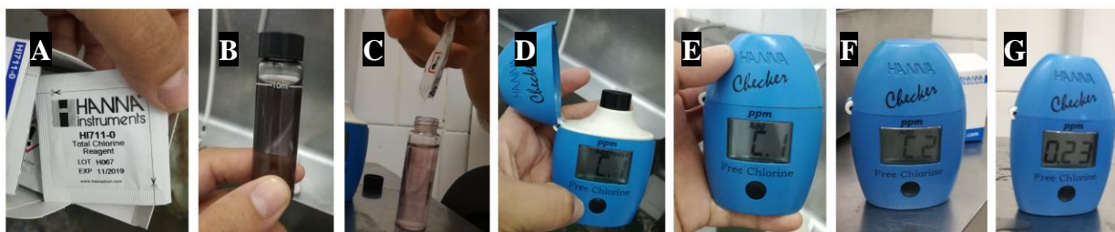
Figura 22 - Pasos para obtener el nivel de cloro de una muestra de agua. A).Reactivo. B).Muestra de agua 10mL. C).Colocación del reactivo a la muestra de agua. D).Colocación de la muestra en el Colorímetro Cloro Libre Digital Hanna checker . E- F).Procedimiento del Colorímetro. G).Resultado de la muestra tomada. Fuente propia.
