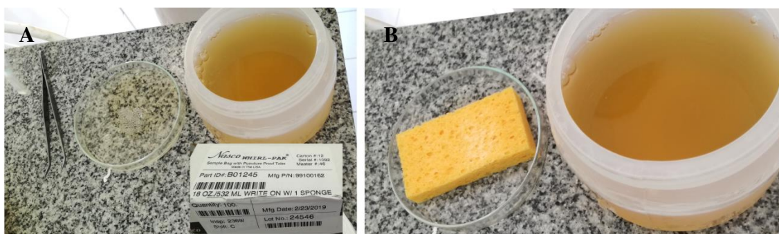
Figura 23 - A).Preparación del medio para el muestreo. B).Colocación del medio en la esponja. Fuente propia.
