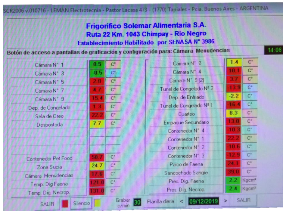
Figura 18 - Fotografía de la pantalla del monitor donde pueden observarse las mediciones del termómetro LEMAN, en los diferentes puntos de la planta. Fuente propia
