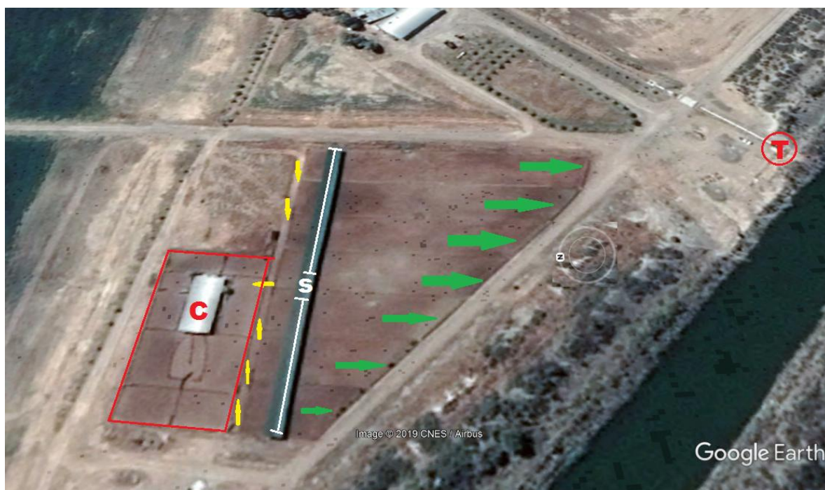
Figura 16. Referencias del establecimiento N° 2. Fuente: Google Earth (T) Tanque de agua (S) Techos para sombra (C) Corrales de trabajo y manga (Flechas amarillas) Callejones don dirección del flujo de animales (Flechas Verdes) Dirección de la pendiente
