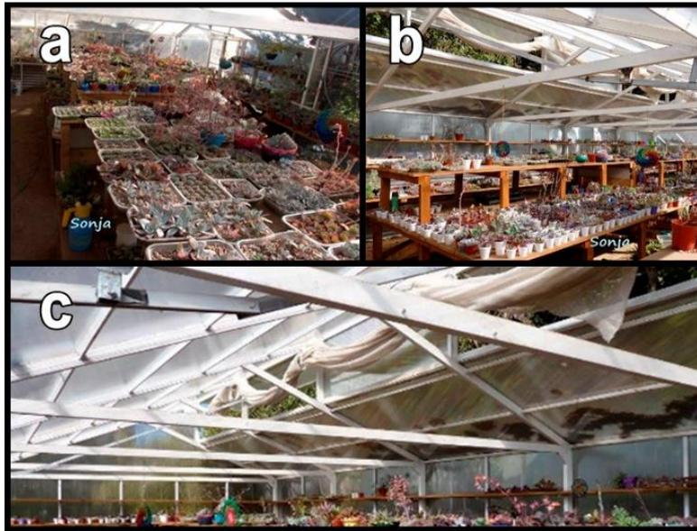
Figura 5. a) Bandejas con plantas destinadas a propagación asexual, sobre mesada en Invernadero 3. b) Estructura de hierro y policarbonato como cobertura. Ventilación cenital pasiva en Invernadero 3. c) Ventilación pasiva y sistema de malla media sombra retraído.
