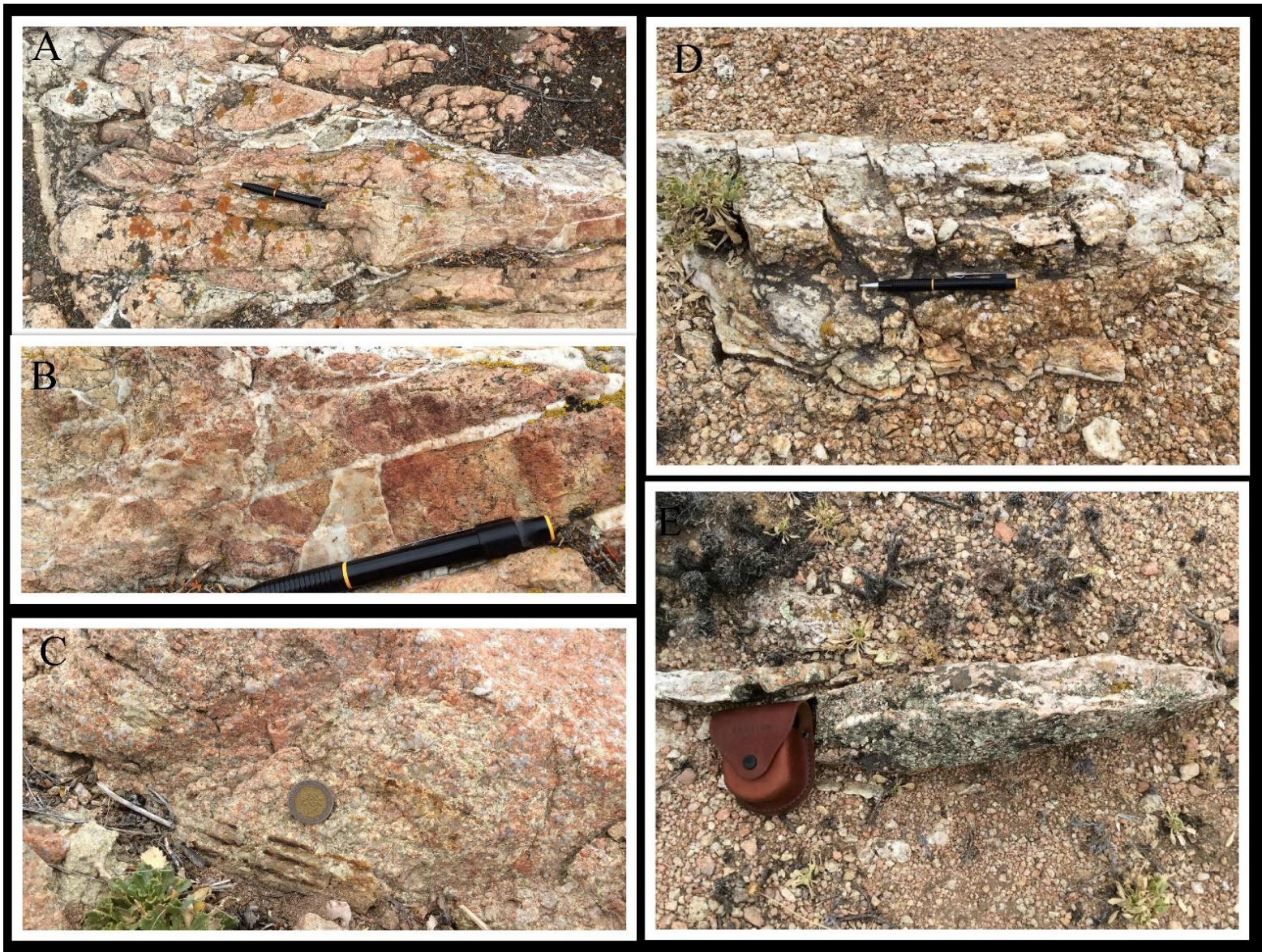
Figura 9 Fotos de los afloramientos dónde fueron tomadas las muestras para análisis mineralógico-textural. A. PAN-13, cataclasita granítica con textura brechosa que afecta a la foliación milonítica. B. PAN-14, granito cataclástico con fractura rellenas con cuarzo lechoso. C. PAN-15, espejo de falla con estrías en un leucogranito. D. PAN-17, brecha tectónica con fracturas rellenas con cuarzo lechoso. E, idem anterior. En todos los casos, notar que los afloramientos son pobres y de reducido tamaño.
