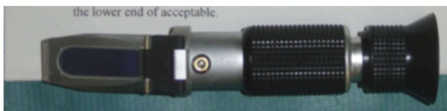
**Imagen N° 7:** Refractómetro de azúcar en grados BRIX
