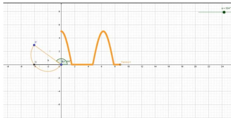
Imagen IV. Aporte del tambor 1 a la sección al viento del rotor
