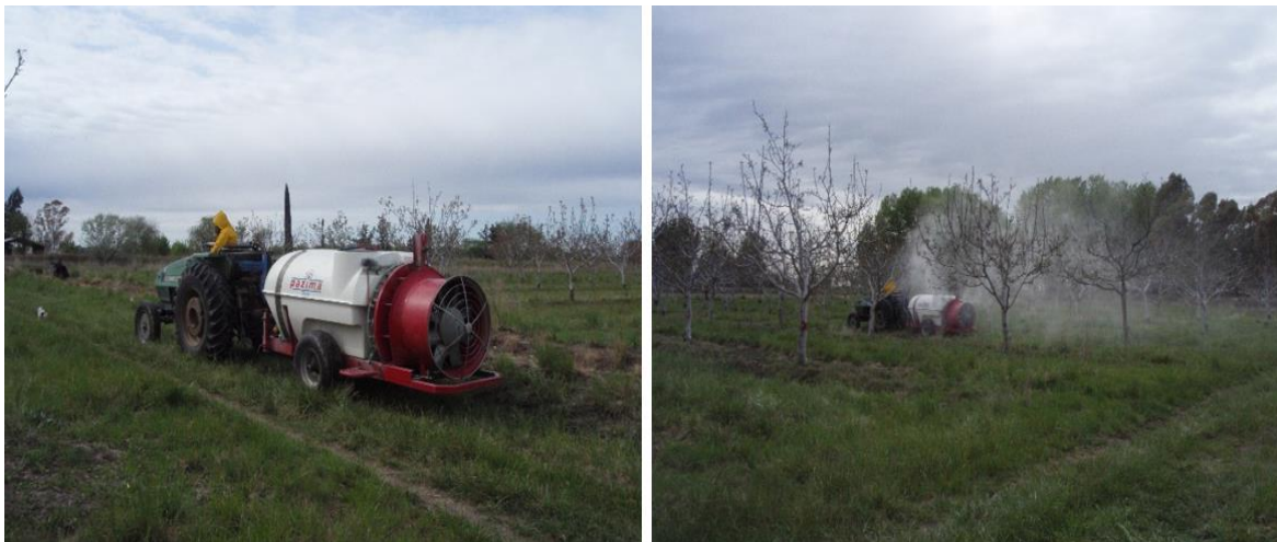
Figura 29. Equipo tractor - pulverizadora utilizado (izquierda) y prueba de aplicación (derecha). Fuente: Imagen propia.
