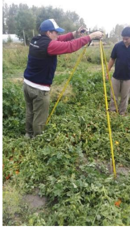
Figura 17. Utilización del trípode para la medición de cobertura siguiendo método propuesto por Campillo et al. , (2008).
