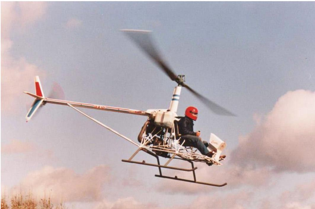
**Figura 41. El modelo CH-6 en un vuelo para prueba de componentes (1987).**
