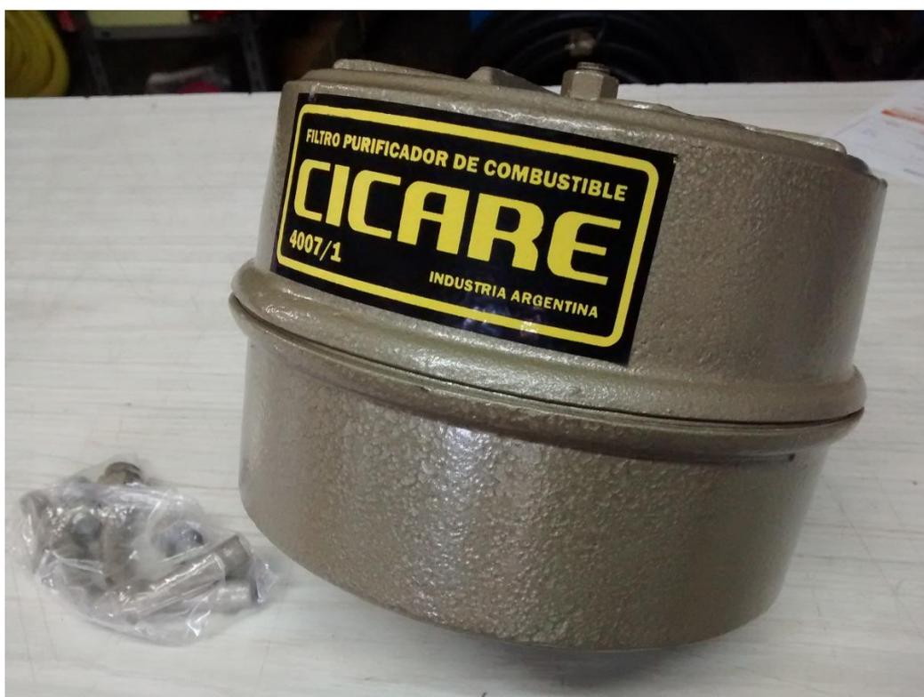
**Figura 69. Filtro de combustible marca Cicaré.**
