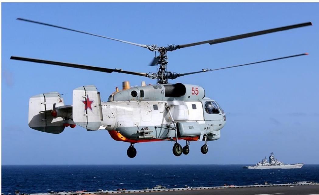
**Figura 14. Helicóptero ruso Kamov Ka-27 de palas contrarrotativas.**
