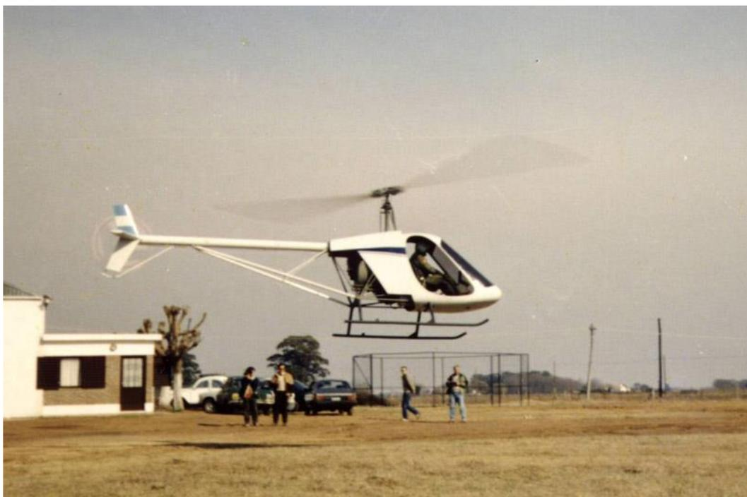
**Figura 40. El modelo CH-5 en un vuelo para prueba de fuselaje (1986).**
