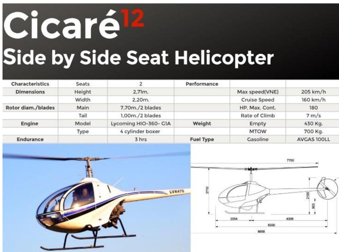
Figura 66. Ficha técnica del modelo CH-12.
