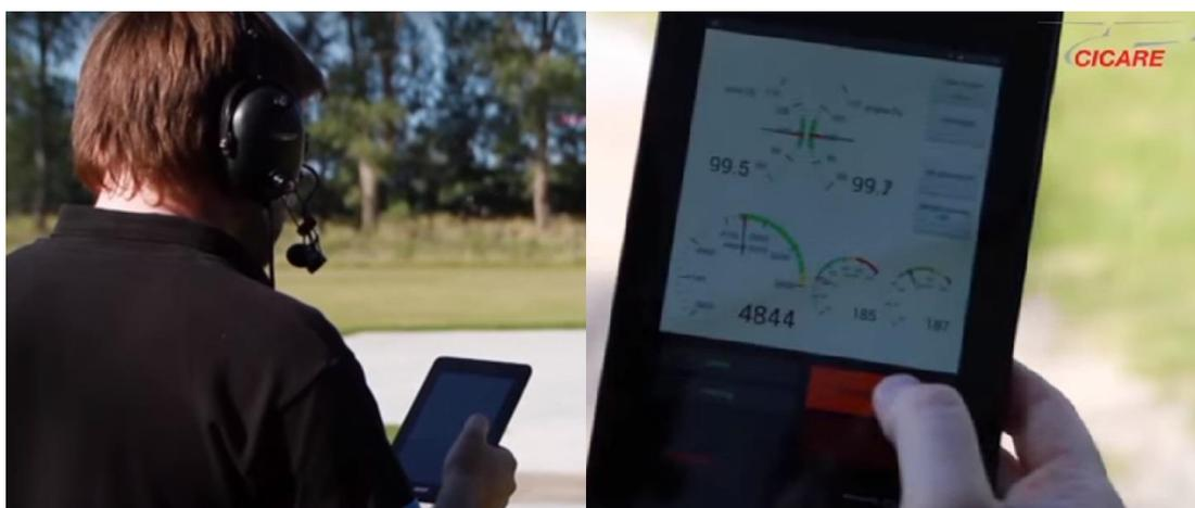
**Figura 61. Sistema de control remoto digital para instructores del modelo SVH-4.**
