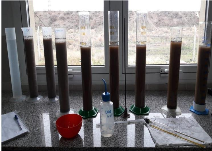
Figura 4. Probetas con suelo para cuantificar la composición granulométrica.
