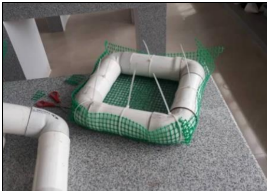
Figura 4.2.8: Diseño de la superficie flotante con tubos de PVC, malla plástica y precintos. Fuente: Ortega Gallegos, 2019.
