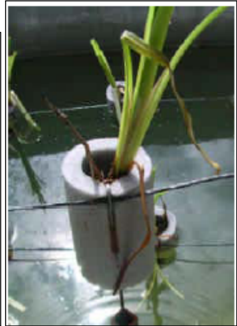
Figura 4.2.5: Estructura flotante compuesta por un recipiente sostenido sobre cables. Fuente: Headley y Tanner, 2008.
