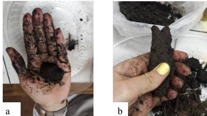
Figura 7: Algunos de los pasos en la identificación manual de la clase textural del suelo. a) humidificación y formación de volumen esférico para determinar propiedades arenosas, b) formación de cinta para identificar otras propiedades.
