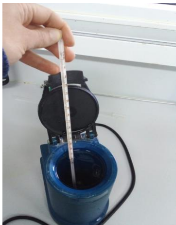
Imagen 8: Descongelador con agua y termómetro.
