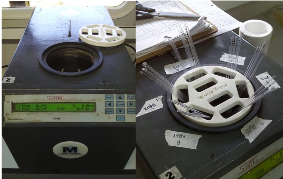
Imagen 28: Congelador programable con metanol. Imagen 29: Pajuelas de TE sumergidas en metanol.
