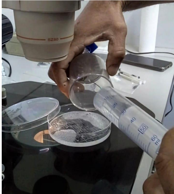
Imagen 17: Limpieza a presión del filtro.
