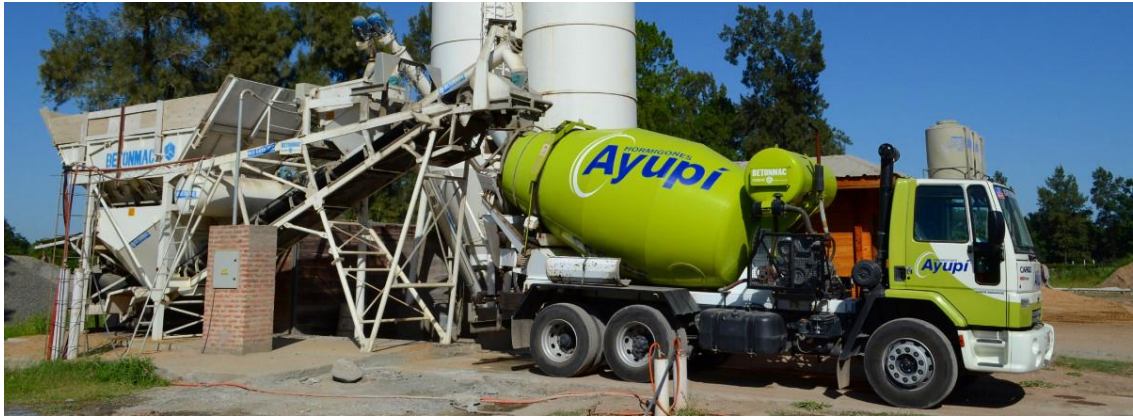
Imagen: Planta dosificadora "NM 70", con camión atracado para recibir los componentes del hormigón.
