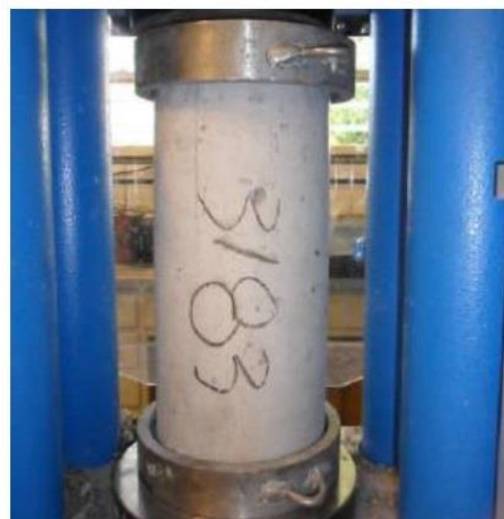
Imagen: Probeta endurecida, lista para ensayo a compresión.
