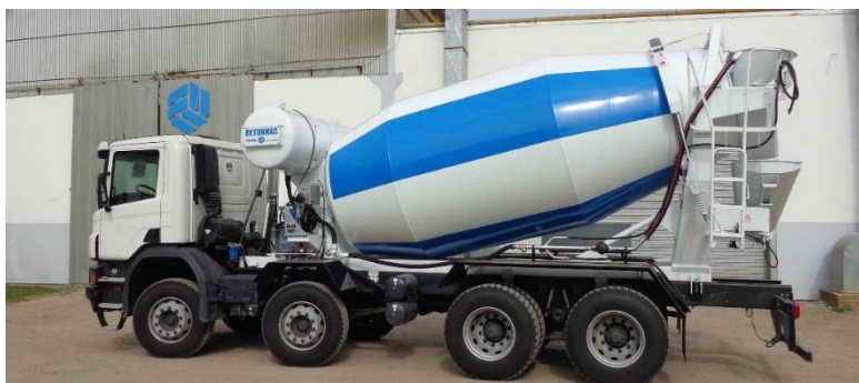
Imagen: Camión con trompo motohormigonero montado sobre chasis.
