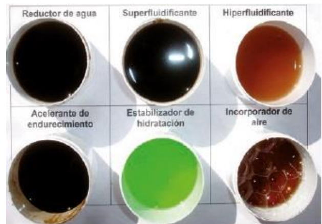
Imagen: Sistema de acopio de aditivos en planta; diferentes clases de aditivos para hormigón.
