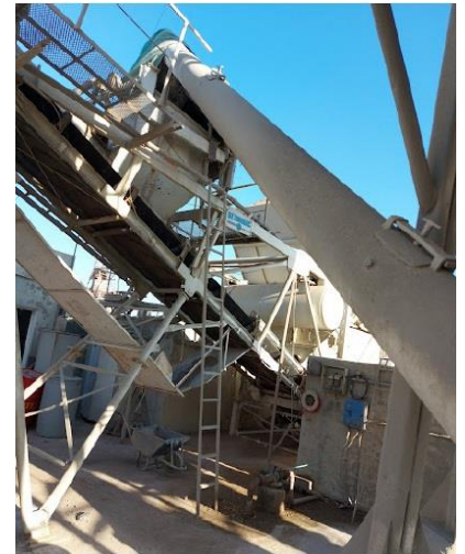
Imagen: Sinfín de cemento y balanza de cemento.
