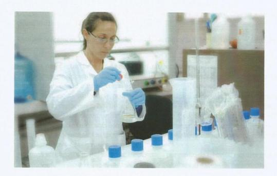
En los Servicios se efectúan análisis bacteriológicos diarios de tipo presencia-ausencia en salida de planta, mediciones de turbiedad, pH, conductividad y cloro residual en planta y diferentes puntos de la red de distribución.
