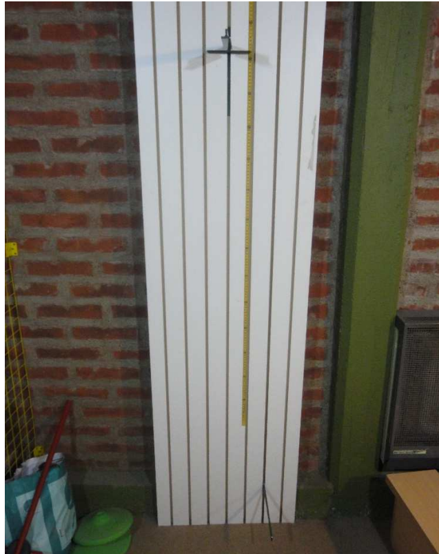
Foto 21. Estadiómetro con rango de medición 50 a 220 cm
