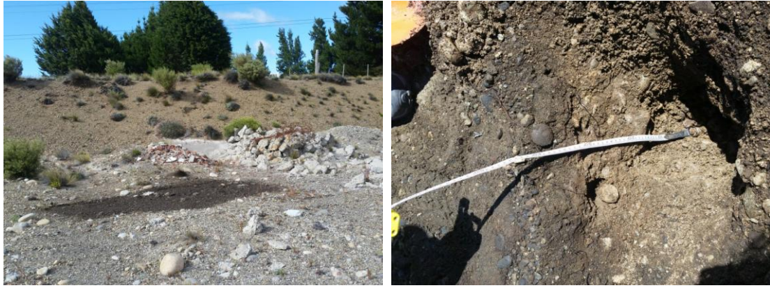
Figura 40 – Sector de la cantera contaminado con hidrocarburos. Izquierda: mancha desde arriba, derecha: profundidad con contaminación (más de 40 cm). Fuente: propia.
