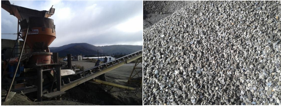
Figura 1 - Triturado del material en canteras de Bariloche. Izquierda: maquinaria de trituración, derecha: piedra partida. Fuente: propia.
