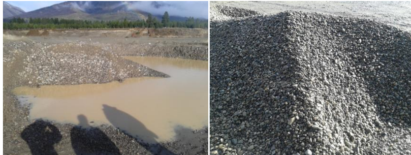
Figura 3 - Lavado de ripio en canteras de Bariloche. Izquierda: laguna de lavado, derecha: ripio lavado. Fuente: propia.
