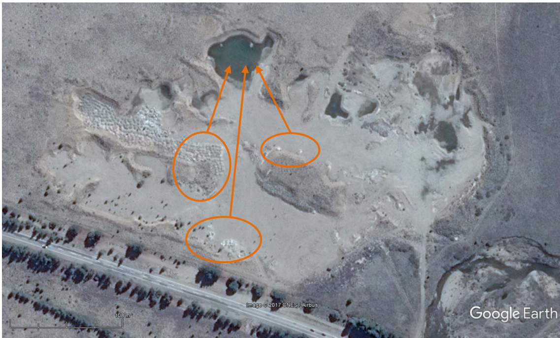
Figura 46. – Uso de escombros y restos de asfalto para relleno. Fuente: elaboración propia a partir de imágenes del Google Earth [fecha: 1/10/16].
