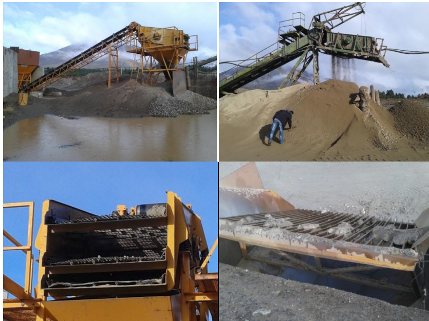
Figura 2 - Proceso de cribado en canteras de Bariloche. Fuente: propia.
