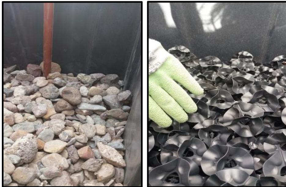
**Figura 27:** Materiales utilizados como filtros; a las izquierda la grava y a la derecha el relleno para biodigestores tipo biolam.
