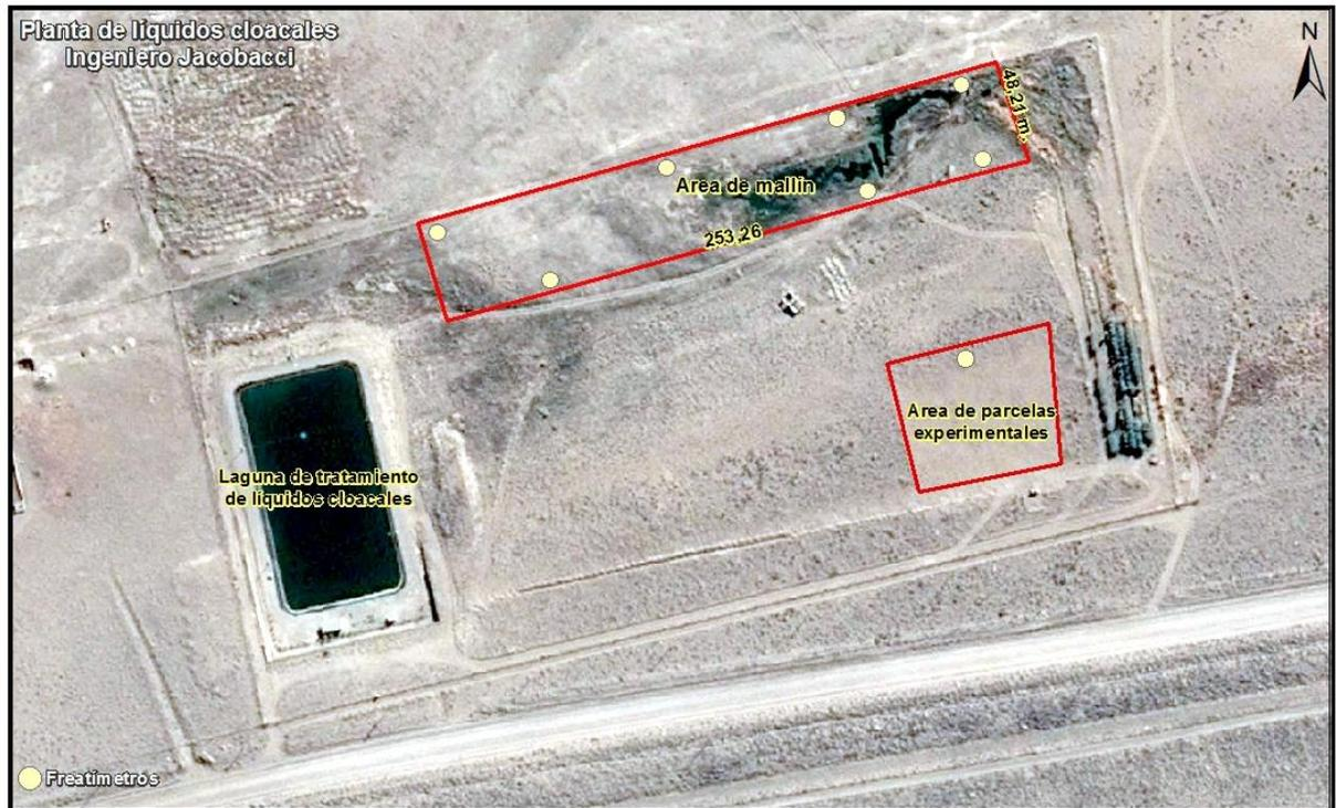
**Figura 28.** Disposición Proyecto red freaticométrica
