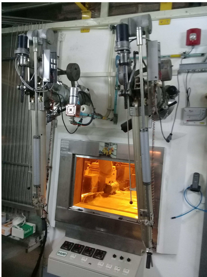
Figura 24: Celda caliente con telemánipuladores instalada en el RA-6 para el proyecto MIPS. Fuente: Analía Soldati, gentileza RA-6.
