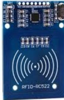
Figura 22: Módulo lector RFID RC522 de 13,56 MHz.
