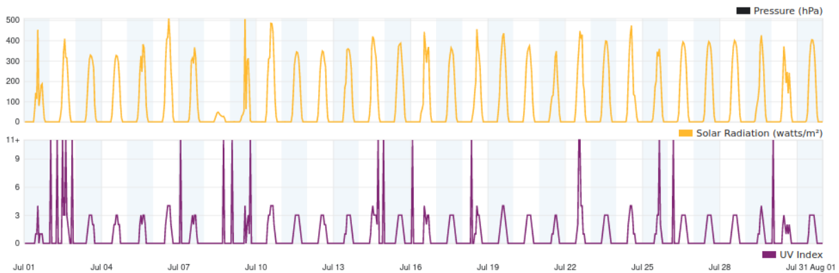
Figura 8: Registros de radiación solar en la costa del Nahuel Huapi cerca del varadero de Parques Nacionales. De los datos podemos aproximar la radiancia diaria en un día típico de julio con 300 W/m 2 durante 4-5 horas, lo que da un total de aproximadamente 50 kWhr para ese mes, consistente con los datos de MERRA2.
